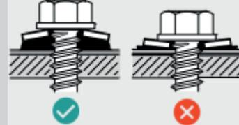
Tenue des vis (avec coef. sécurité: 2) :  $P_k = 70$  daN/vis
