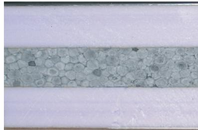
Gama de panel de relleno: Espesor 58, 65, 95 mm
